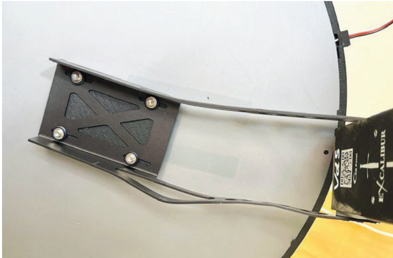
3 Verbogenes 12-Zoll-Flatpanel nach einer Kollision mit dem Rolldach (Bild: Jürgen Obstfelder)
